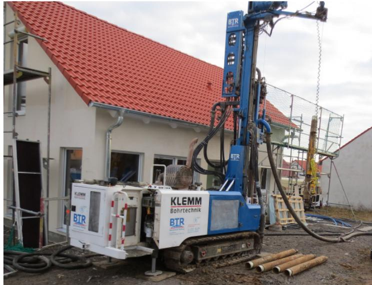
Der zweifach schwenkbare und höhenverstellbare Steuerarm, der mit allen notwendigen Bohrfunktionen ausgestattet ist, lässt sich optimal an den jeweiligen Aufstellort des Gerätes anpassen. Dies ermöglicht eine freie Sicht auf den Bohransatzpunkt und die dreifach Klemm- und Brechvorrichtung.
